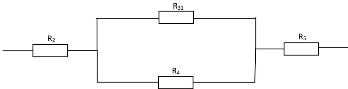
Drugi korak rješavamo paralelni spoj otpornika  $R_{31}$  i  $R_4$
